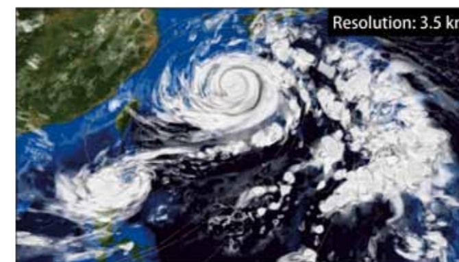
全球大気シミュレーション(台風の部分を拡大) 従来の最高解像度(水平格子3.5km)(左)に比べ、今回「京」で行ったシミュレーション(水平格子870m)(右)は雲の様子がより正確に再現されていることが分かる。
