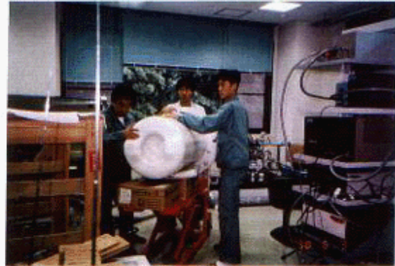
◎頭をつつむ様に加工された FRP デュア-の先端部 ・内部に 64 ヶの SQUID センサーが配列されている
