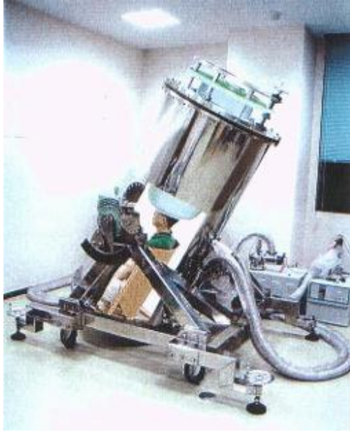
実際に作製した 全頭型 SQUID-脳磁界計測装置
