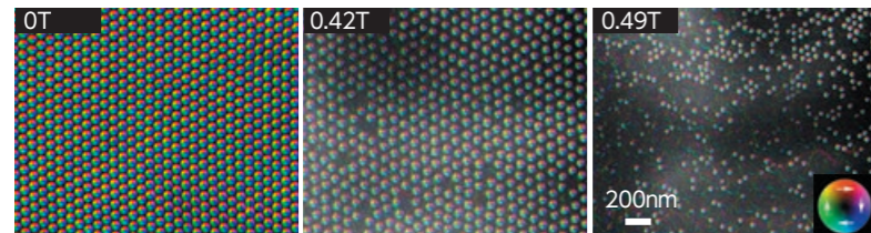
図3 スキルミオン結晶の崩壊 FeGe薄膜に0.1Tの磁場を加え、室温から極低温まで急冷すると広い温度・磁場領域に準安定相のスキルミオンが存在し続ける。極低温で外部磁場をかけないゼロ磁場にしても、スキルミオンは三角格子の密な結晶を保つ(0T)。外部磁場を強くしていくと、スキルミオンのない領域がランダムにでき始め(0.42T)、結晶が崩壊してばらばらになる(0.49T)。カラー粒子はスキルミオンのスピンの向きを色分けしたもので、右下凡例が色とスピンの向き(矢印)の対応。黒色は薄膜試料に垂直なスピン。
